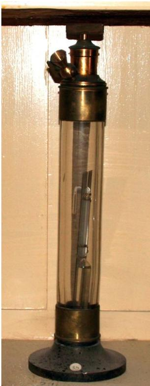
*Piezómetro de Oersted.*
